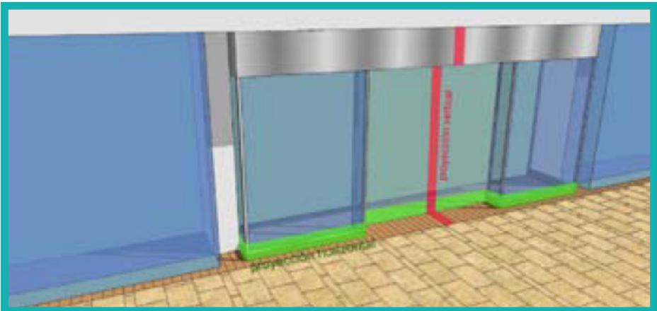
La fachada debe tener en su estructura un zócalo no menor de 10 cm. sobre el cual se apoye el vidrio, el cual estará recubierto de un material duradero y resistente a los golpes y maltratos inherentes a la limpieza y pulido de los pisos. Con el ánimo de ilustrar los criterios propuestos incluimos algunas alternativas de diseños de fachadas:
